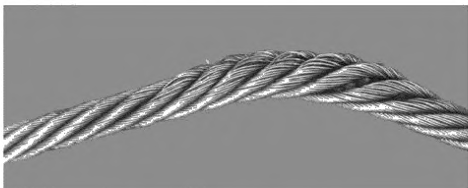
Рисунок А.5 — Сплющивание (перезатие каната)
