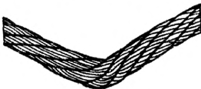
Рисунок А.20 — Залом каната
