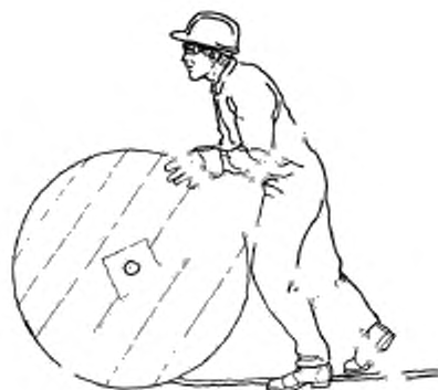
б) Разматывание каната с бобины
