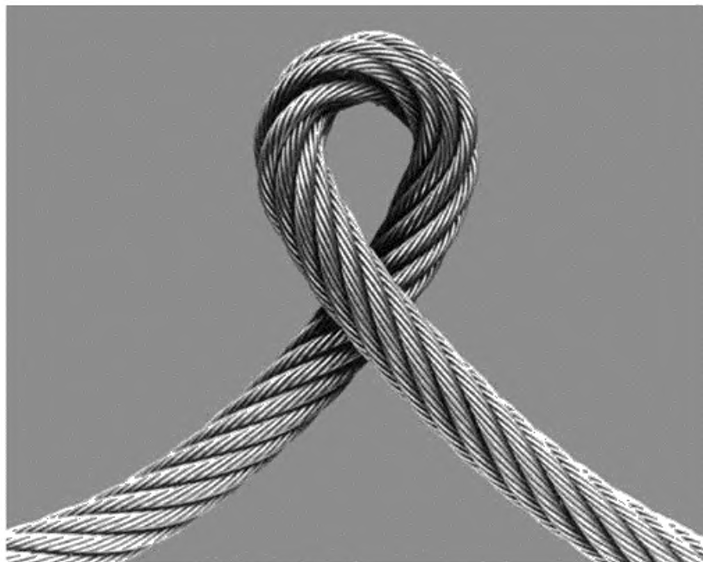
Рисунок А.17 — Перегиб каната
