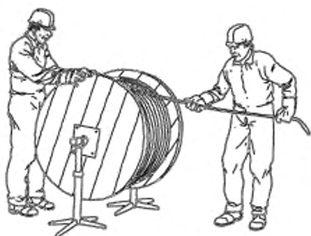
б) Разматывание каната с бобины
