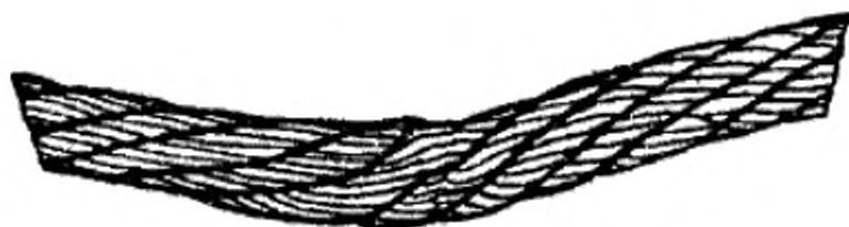
Рисунок А.21 — Искривление каната
