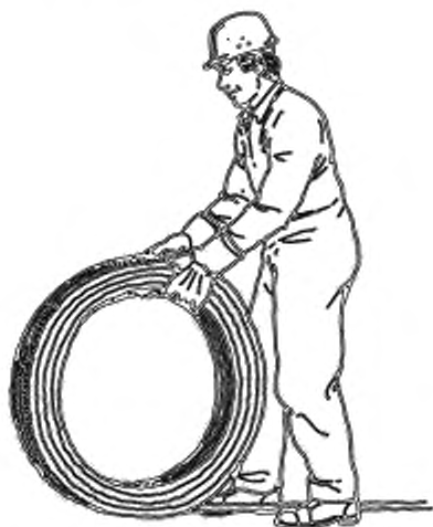
а) Разматывание каната из бухты
