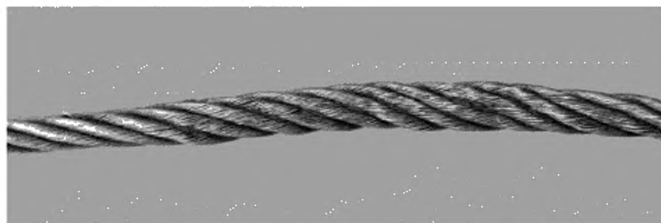
Рисунок А.18 — Сплющивание (пережатие каната)
