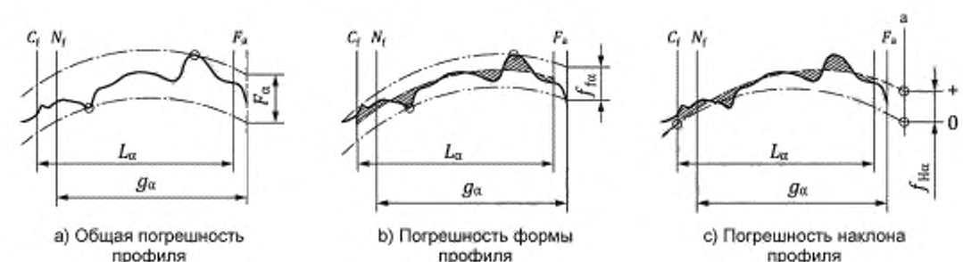
Рисунок 5 — Погрешности профиля с модифицированным углом зацепления
