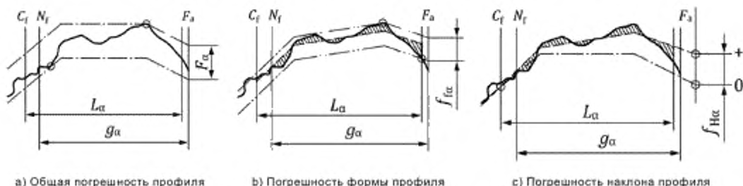
Рисунок 7 — Погрешности профиля с модифицированной головкой
