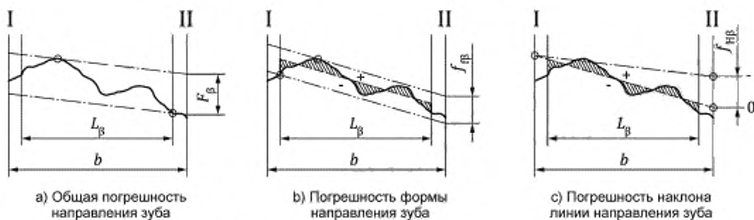
Рисунок 10 — Погрешности направления зуба с модификацией угла наклона зуба
