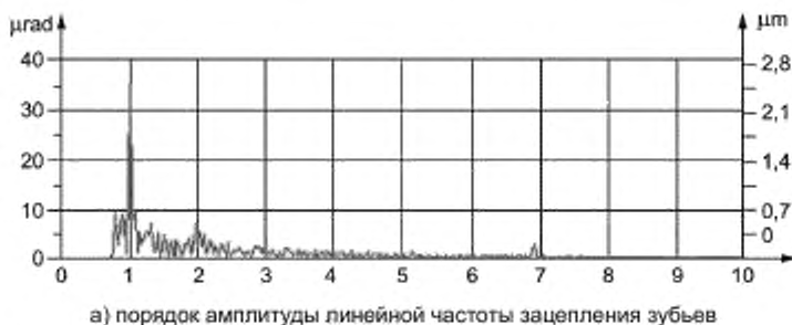
Рисунок F.4 — Преобразование Фурье однопрофильной кинематической погрешности, лист 1
