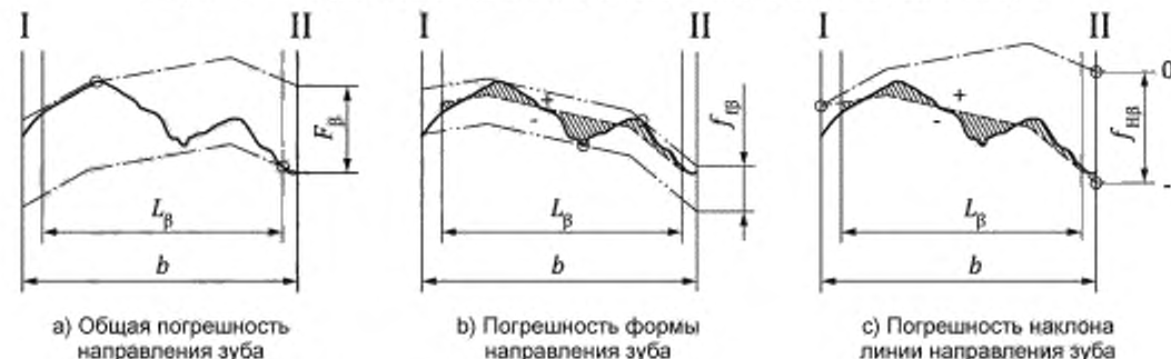
Рисунок 12 — Погрешности направления зуба со срезом у торца по направлению зуба
