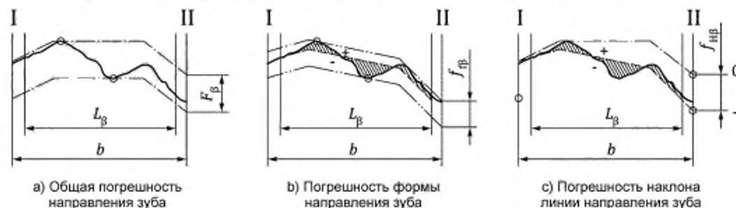
Рисунок 11 — Погрешности направления зуба с бочкообразной модификацией по направлению
