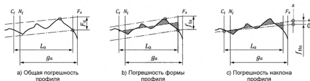
Рисунок 4 — Погрешности профиля с немодифицированной эвольвентой
